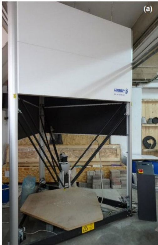
Figura 3-20. (a) Impresora 3D tipo Delta. (b) Cabezal d
